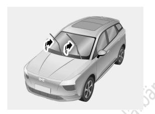
Drücken Sie die Taste des Wischerarms und ziehen Sie das obere Ende des Wischerblattes nach außen, um es vom Wischerarm zu lösen
